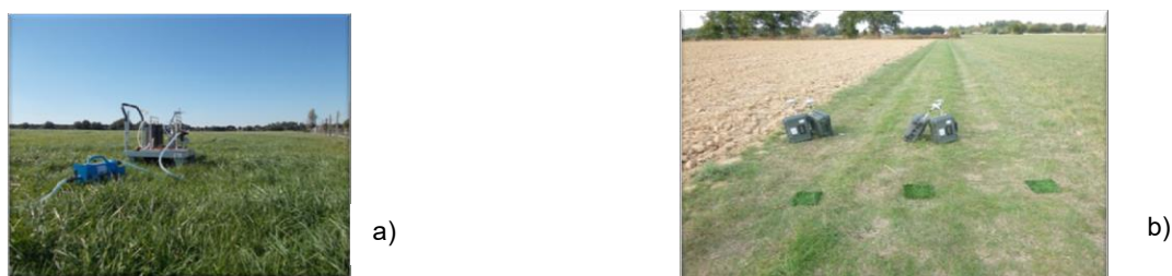
Figure 3 a) : Générateur pneumatique de fluorescéine déployé sur le terrain. b) : filtres et herbes synthétiques pour la mesure des vitesses de dépôt de fluorescéine.
