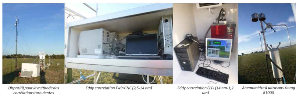
Figure 2 : Dispositifs utilisés pour la mesure de vitesse de dépôt sec par la méthode des corrélations turbulentes.
