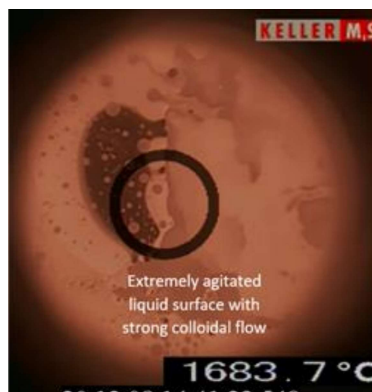
Chauffage d'un échantillon de corium (simulant une découpe thermique)
