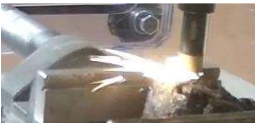
Découpe mécanique d'un bloc de corium
