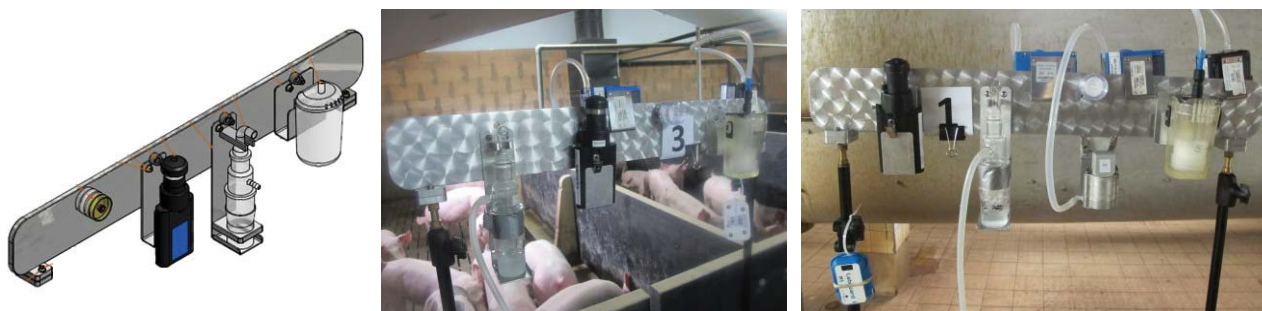
Figure 1. Photographies de la barre de prélèvement pour la comparaison des biocollecteurs
