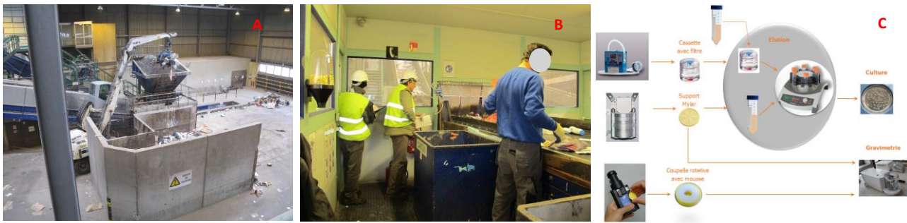
Figure 1 : Conditions de prélèvement et d'analyses des échantillons de bioaérosols dans le centre de tri. A : zone de broyage ; B : cabine de tri ; C : description des analyses.
