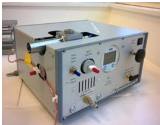
Figure 1 - À gauche le Combustion Aerosol Standard Generator (CAST) et à droite la configuration de la chambre de combustion du CAST.
