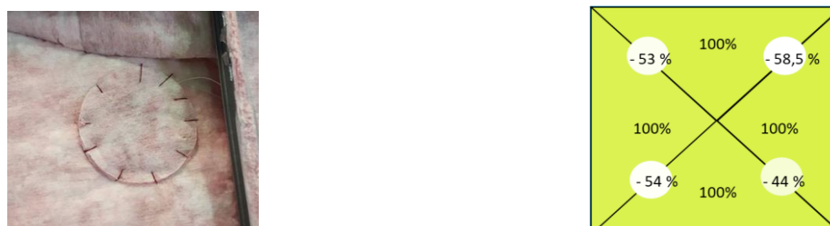
Figure 2 : A gauche, coupon de média filtrant fixé à la surface d'un filtre à poches ; à droite, répartition zonale normée de l'écoulement dans un échantillon de média filtrant muni de quatre coupons.
