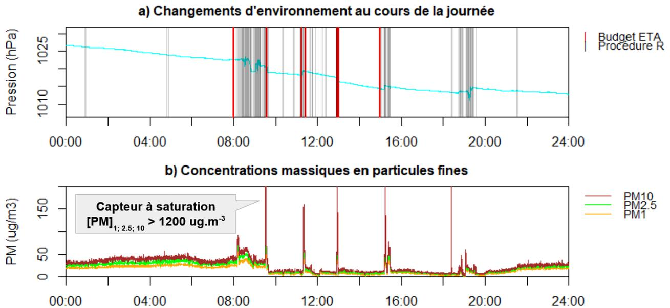
Figure 2. a) Segmentation des données b) Concentrations en particules fines au cours du temps
