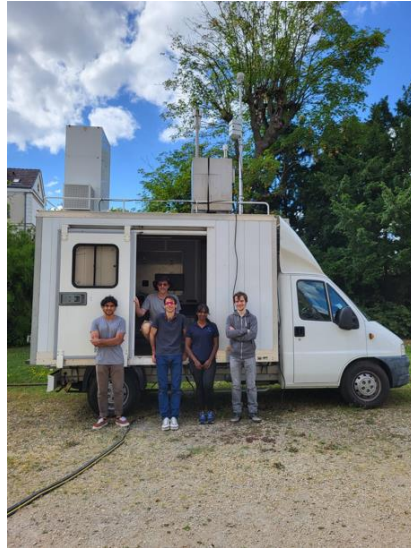
Figure 1. Photo de la station MAS (Mobile Atmospheric Station) prise sur le site de l'Observatoire de Paris. Le lidar WALL est implémenté à bord du camion. Sur le toit de la station sont installés un appareil de mesure FIDAS ainsi qu'un analyseur de particules Black Carbon.
