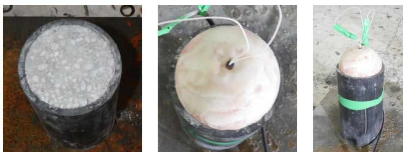
Figure 1. Epreuve en béton et explosif au contact
