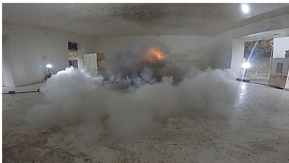
Figure 3. Dispersion des aérosols suivant la détonation
