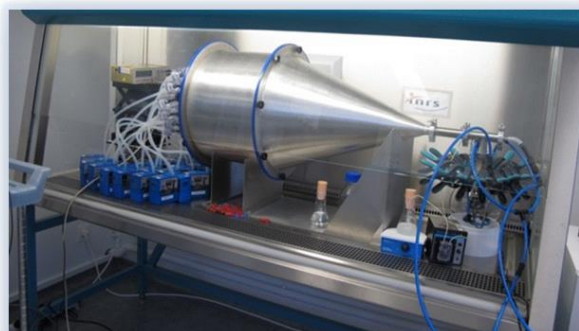
Figure 1 : banc d'essai utilisé (à gauche) et exemples de suivi de la concentration en nombre de particules/cm 3 obtenus à l'aide d'un compteur optique de particules OPS 3330 (à droite).
